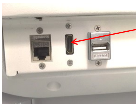
11 pav. Antrojo monitoriaus išvesties (HDMI) jungtis
