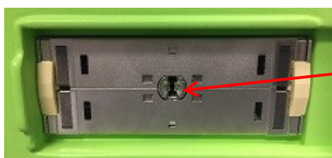
20 pav. Užrakto skylutė keitiklio jungties lizde
