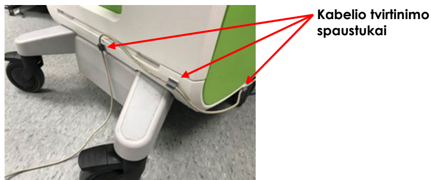
4 pav. Kojinio pedalo kabelio tvarkymas
